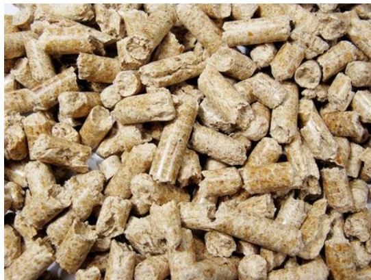
Kuva 3. Biokattiloissa polttoaineena käytetty puupelletti [25]
