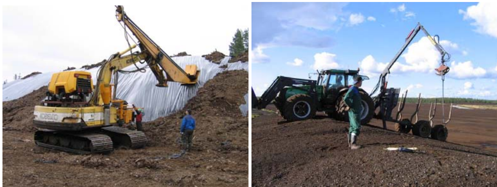
Kuva 5. Seuranta-aumoista kairattiin näytteet tuotantokosteuden määrittämiseksi.
