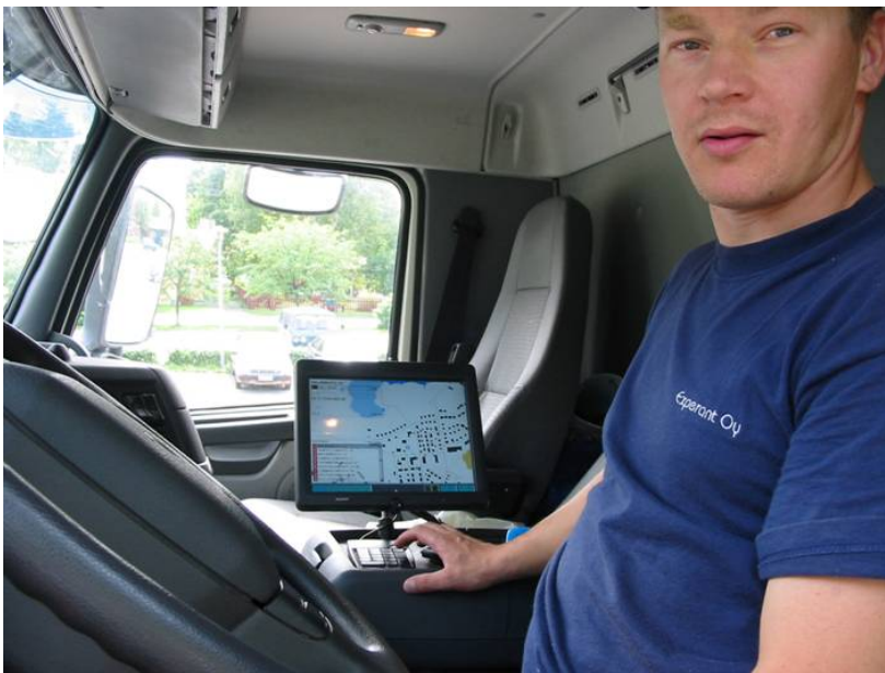
Kuva 17. Ecomondin logistiikanohjausjärjestelmän ajoneuvopäätelaitteet (lähde: Ecomond 2007).
