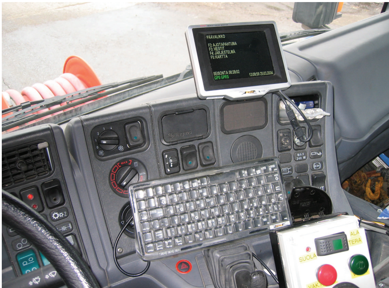
Ajoneuvojen seurantajärjestelmä auton ohjaamossa.
