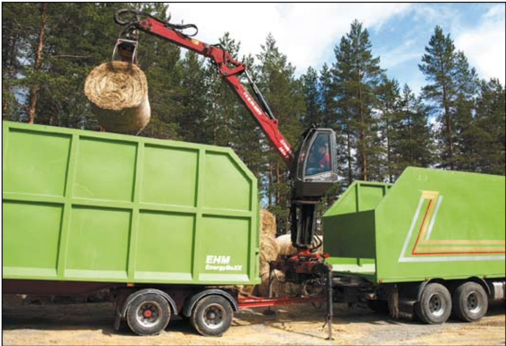
Helpipaalien lastausta helven kuljetukseen suunniteltuun yhdistelmäajoneuvoon (Kirsi Knuuttila, Jyväskylä Innovation Oy)
