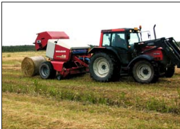
Ruukohelven paalaus sujuu kiinteäkammioisellakin pyöröpaalaimella vaikka muuttuvakammioista paalainta pidetään parempana. (Timo Lötjönen, MTT).
