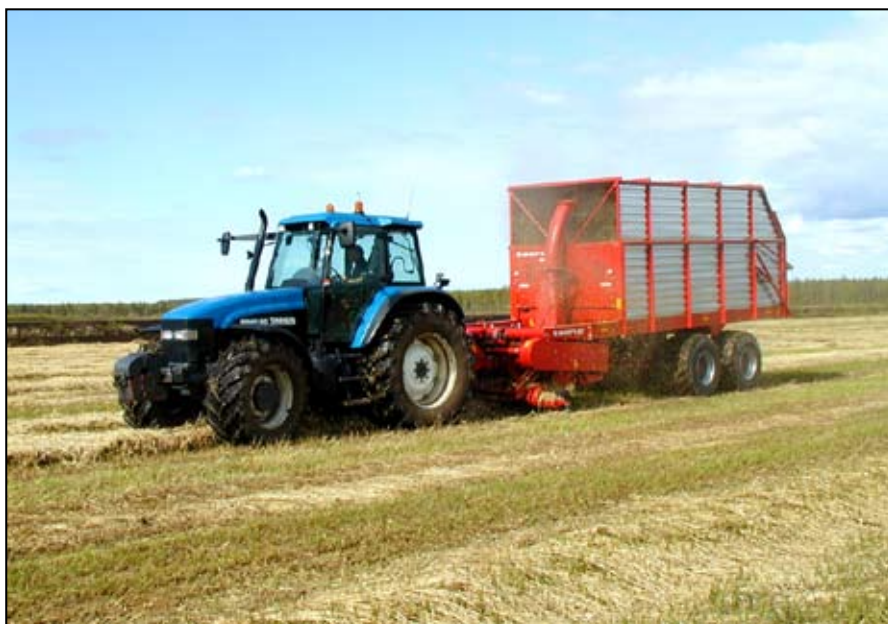
Irtosilppukorjuuta tarkkuussilppurivaunulla. (Timo Lötjönen, MTT)
