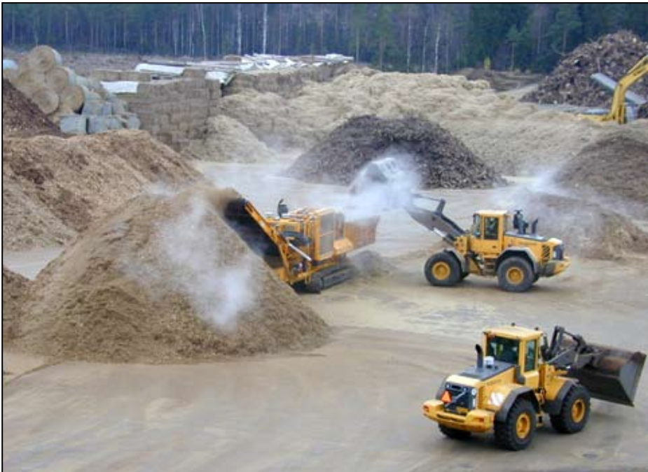
Ruokohelpi-turvesoksen valmistaminen puumurskaimella voimalaitosalueella.. (Timo Löijönen, MTT)
