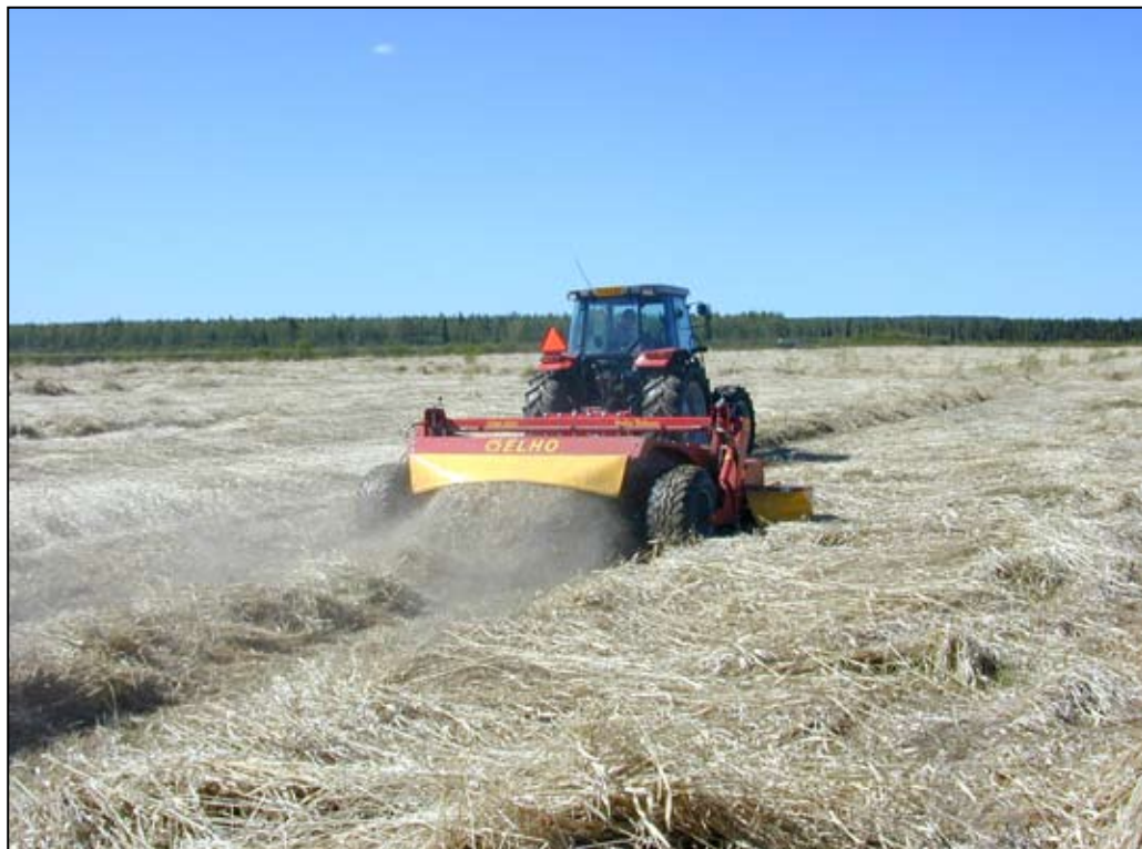
Niittomurskain työssä. Lumi on painanut kasvuston maata vasten, joten niittokone säädetään leikkaamaan lyhyeen sänkeen. (Timo Lötjönen, MTT)
