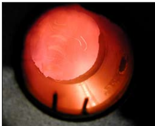
Turve-ruukohelpiseos palaa leijupetikattilassa puhtaasti. (Timo Lötjönen, MTT)
