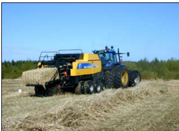
Kantipaalaimen etuna ovat tiiviit ja hyvän muotoiset paalit. (Timo Lötjönen, MTT)
