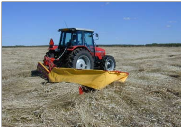
Lautasniittokoneen jäljiltä pelto on karhotettava, mutta korjuutappiot ovat yleensä pienemmät kuin niittomurskaimella. (Timo Lötjönen, MTT)
