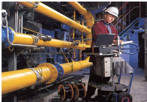
Kuva 28. Kaasuvirtausmittauksen kenttäkalibrointi merkkiainemenetelmällä.
