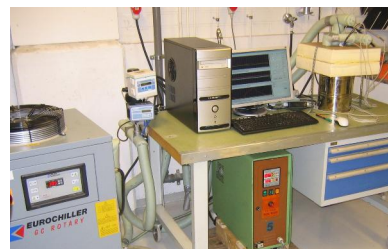
Lämpöakun ensimmäinen laboratorio- prototyyppi ja sen testauslaitteisto.
