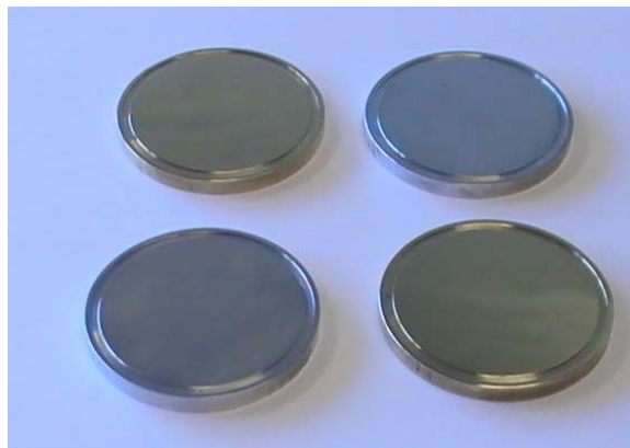
Kuva 5. Alumiinisista ja messingistä valmistettuja jäähdytysjärjestelmän kiekkoja. Levyn reunalle on sorvattu ura. Uran merkitys on erottaa koko metallipinnan kattavat nestekerrokset koelaitteiston reunapinnoista. Erottuminen voi tapahtua nesteen pintajännityksen perustuen (neste ei tunkeudu uraan vaan jää reunalle) tai uraan voi laittaa tarkasteltavaa nestettä hylkivää ja inerttiä nestettä.
