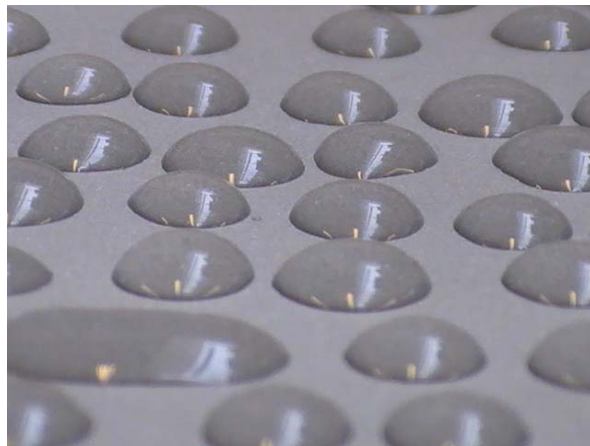
Kuva 6. Alijäähtyneitä suolahydraattinestepisaroita alumiinilevyllä. Kuvan suurin pisara on jätetty tarkastelusta pois.
