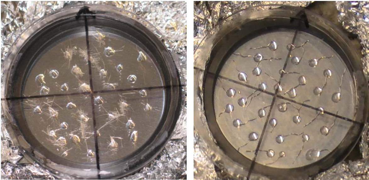
Kuva 16. Kiteytymisen käynnistymistä edistäviä häiriötekijöitä. a) hamppukuituja, b) alumiinilanganpätkiä.
