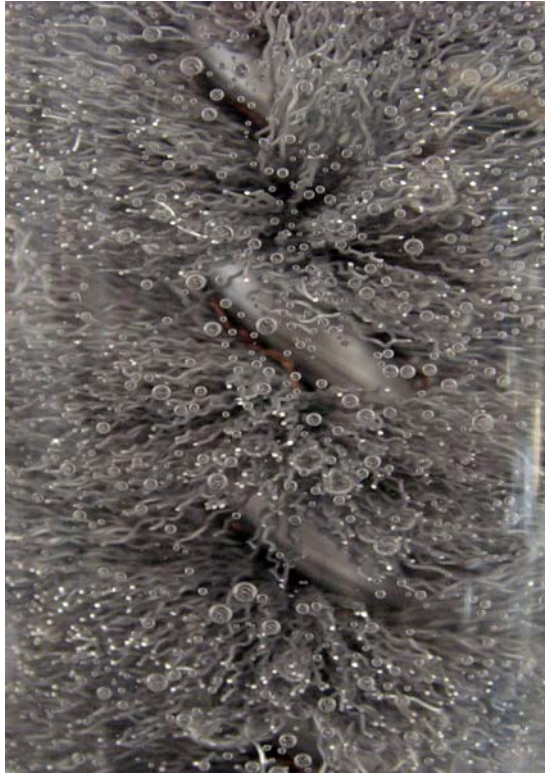
Kuva 38. Lämmönvaihdin pinnoille nestemäiseen SAT:iin syntyviä kaasukuplia.
