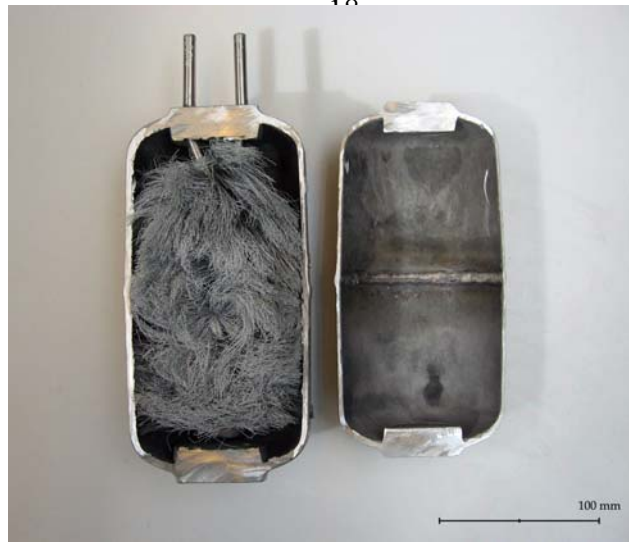
Kuva 9. Halkaistu Hydrocell Oy:n valmistama harjalämmönvaihdinyksikkö [4].
