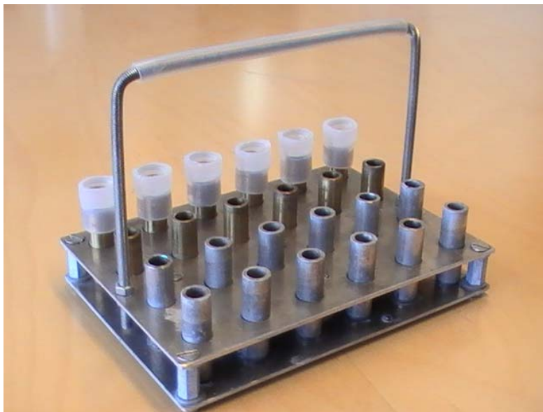
Kuva 7. Alumiinista ja messingistä valmistettuja testikapseleita. Takarivin messinkikapseleihin on asennettu mittauksissa käytetyt kiteytymisen visuaalisen tarkastelun mahdollistavat korkit.
