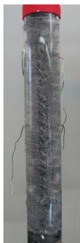
Kuva 11. Putkimainen harjalämmönsiirrinlaitteisto (BHXA-C). Harjavaihdin sijaitsee läpinäkyvän putkilon sisällä. Lämmönpurkukokeissa laitteisto eristettiin vuorivillalla.
