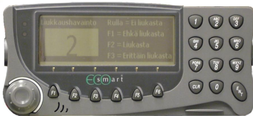
Kuva 6.1. Päätelaite näyttää nykyisen liukkaustason isona numerona 1-3 (1= mahdollisesti liukasta, 3 = erittäin liukasta). Kuljettaja voi antaa oman arvionsa liukkaudesta painamalla alaosassa olevia näppäimiä.
