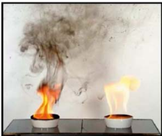
Kuva 5.3. Tavanomaisen (vasemmalla) ja synteettisen dieselpolttoaineen (oikealla) palaminen avonaisessa astiassa. (ASFE 2006)
