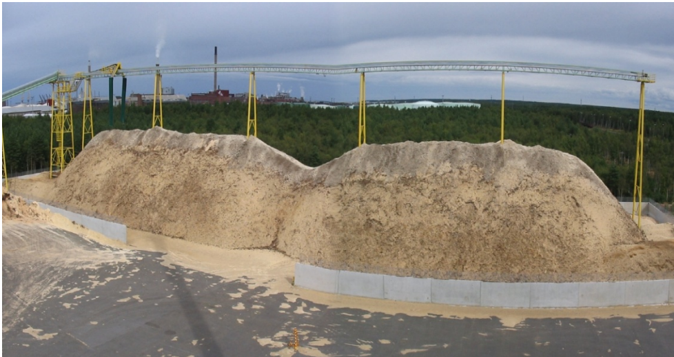
Kuva 13 Biopolttoaineauma Kokkolan Voiman voimalaitosalueella. Auman mitat: pituus n. 140 m, leveys n. 40 m ja korkeus n. 15 m.
