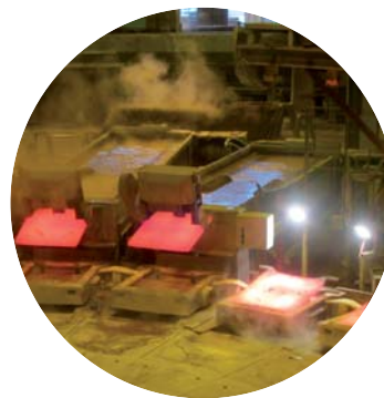
Vasemmalli: Anodien nostimet, joilla esijäähdytetyt anodit nostetaan varsinaisiin jäähdytyslaitaisiin. Keskellä: Punnitsevut valukipit, joiden ansiosta pystytään valamaan tarkasti samanpainoisia anodeita. Oikealla: Kuparisulaton virtauskaaviota.
