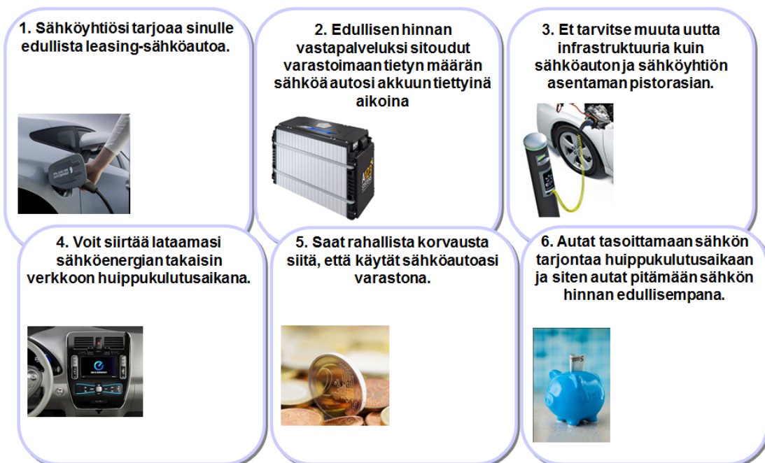
Kuva 2 Sähkön varastointi sähköauton ajoakkuun. /5/
