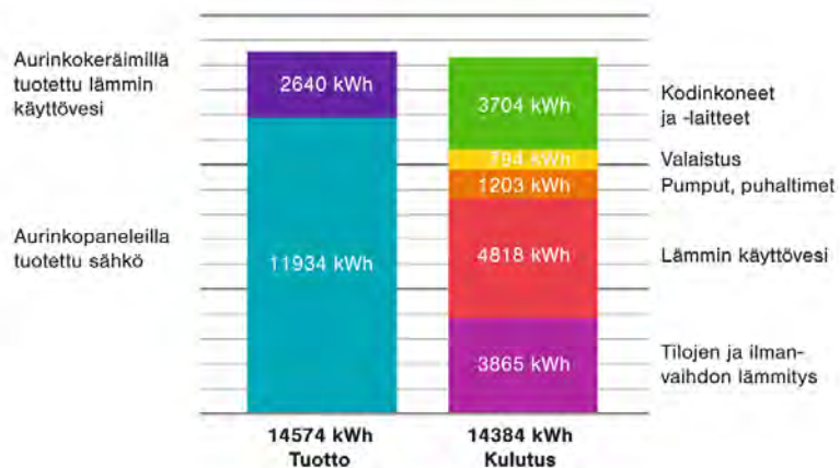
Lantin Energiantuotto ja -kulutus. Kuva: Lantti-esite, Asuntomessut 2012.
