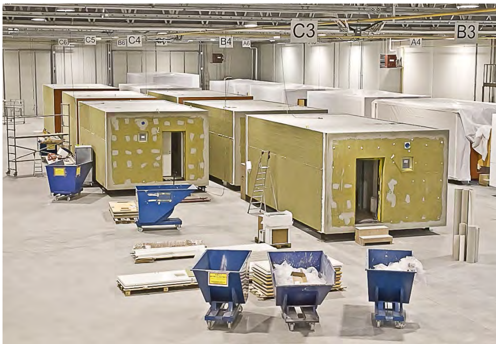
Vantaan moduuleja tehtaalla odottamassa rappausta. Kuva: NEAPO Oy.
