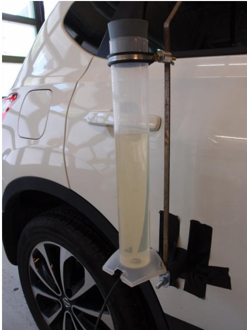
Kuva 1. Polttoainekäyttöisen lämmittimen polttoainemäärän mittaus mittalasilta.
