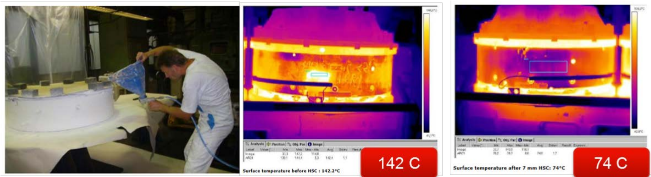
Kuva 36. Esimerkki ruiskueristyksestä ja sen vaikutuksella pintalämpötiloihin (www.specoating.com)
