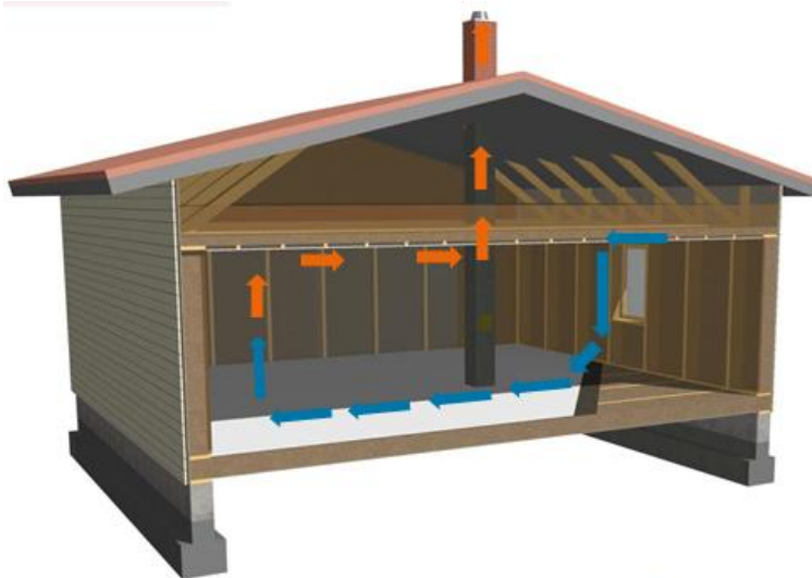
Kuva 9i Painovoimaisen ilmanvaihdon toiminta. Kuva builduppskills
